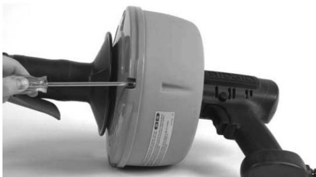
Figura 6 – Slăbiți cele patru (4) șuruburi din jumătatea din spate a cutiei cu circa 3 (ture) complete
