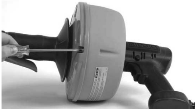
Slika 6 – Otpustite četiri (4) vijka iz stražnje polovice spremišta za oko tri (3) puna okreta
