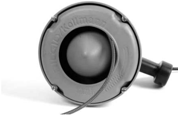
Abbildung 7A – Beim Einlegen einer Spirale in eine Innentrommel müssen Sie die Spirale im Uhrzeigersinn aufwickeln
