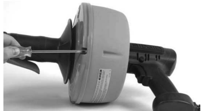
Figuur 6 – Draai de vier (4) schroeven van de achterste helft van de buitentrommel ongeveer drie (3) volledige slagen los
