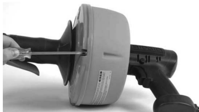
Rysunek 6 – Odkręcić cztery (4) śruby z tylnej połowki pojemnika o około trzy (3) pełne obroty
