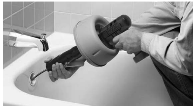
Obrázek 5 - Mezi otvorem odpadu a přední částí přístroje zachovejte vzdálenost do 6 " nebo méně.
