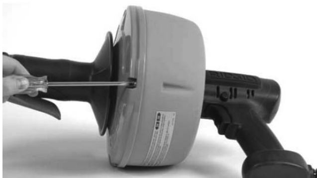
Рис. 6 – Слегка отвернуть четыре (4) винта с задней половины коробки примерно на три (3) полных оборота
