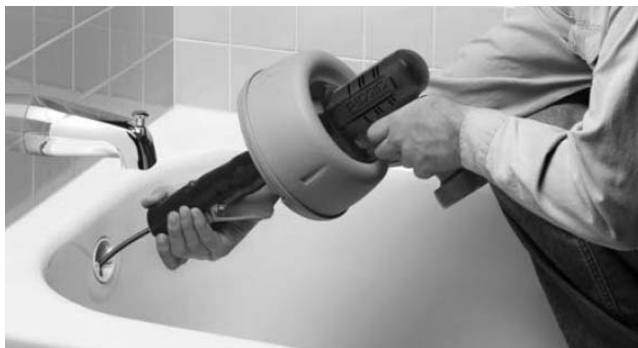
Abbildung 5 – Halten Sie zwischen Abflussöffnung und Kopf des Rohrreinigungsgeräts einen Abstand von maximal 6"
