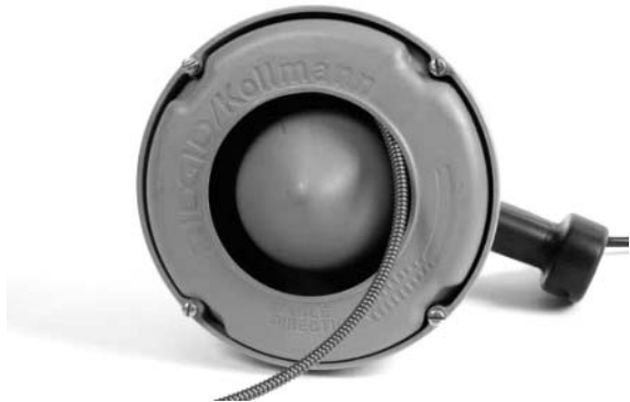
Figure 7A – Quand vous chargez le câble sur un tambour interne, enroulez-le dans le sens des aiguilles d'une montre
