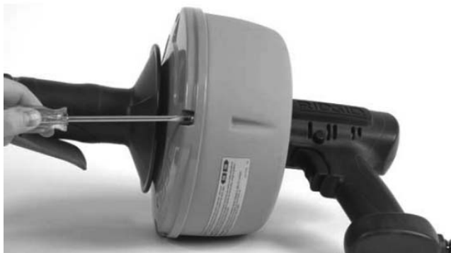
6. ábra – Lazítsuk meg a tartály hátsó felének négy (4) csavarját kb. három (3) teljes fordulatnyit
