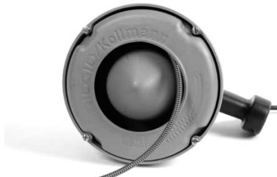
Рис. 7А – При загрузке спирали во внутренний барабан наматывать спираль по часовой стрелке
