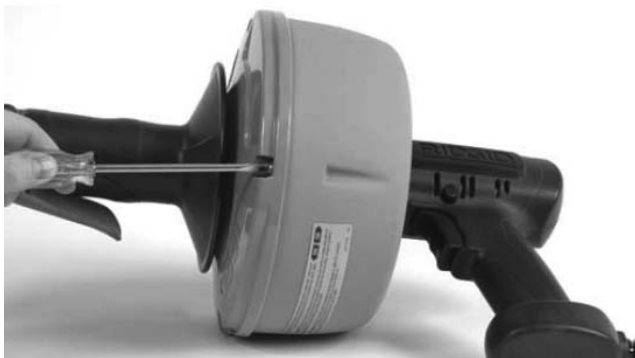
Figura 6 – Allentare quattro (4) viti dalla metà posteriore del contenitore di circa tre (3) giri completi
